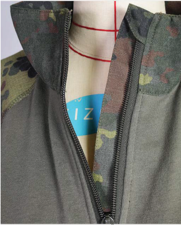
Abbildung 6: RV Vordere Mitte geöffnet Hinweis: RV-Endstück muss verdeckt eingearbeitet werden
